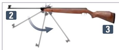
1. Para amartillar el rifle, sujeté la culata **3** con una mano y presione hacia abajo la boca del cañón **2** con la otra hasta que el cañón encaje de manera audible.
