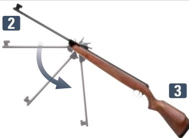
2. Halten Sie das Gewehr mit der einen Hand am Schaft **3** und drücken mit der anderen Hand den Lauf **2** nach unten, bis dieser hörbar einrastet.
