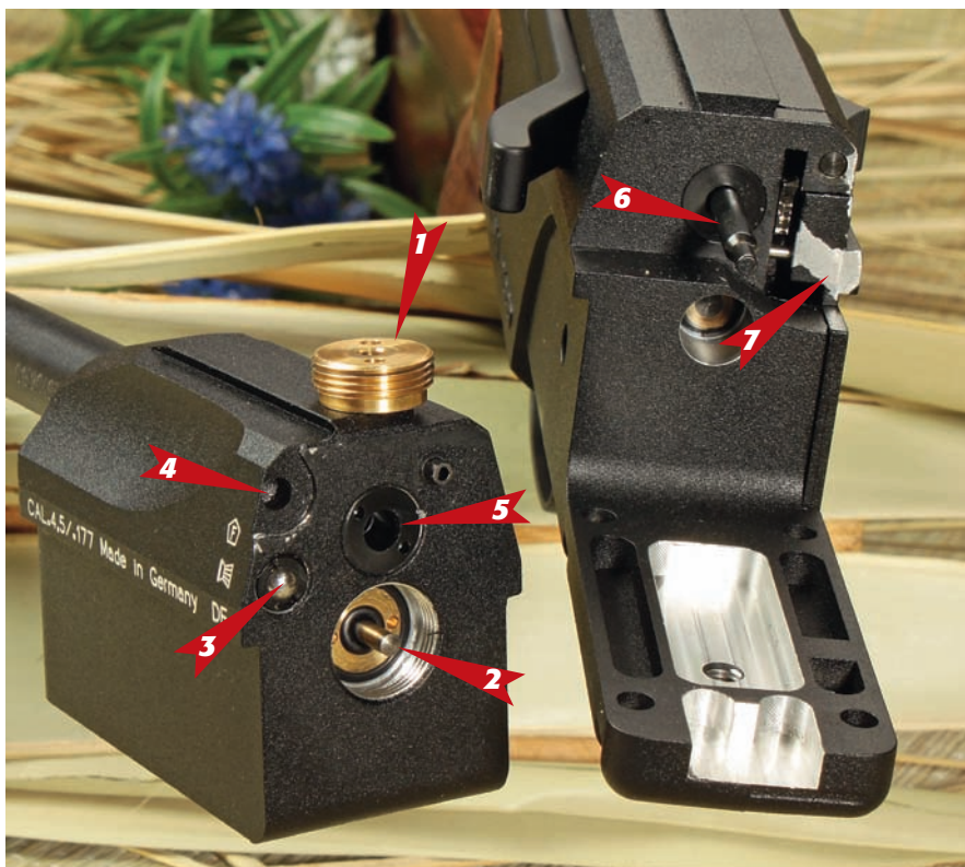
Oben: Der justierbare Metallabzug T06, mit Bohrungen im Abzugsbügel für den Schraubendreher. Unten: demontiertes System beim F-Modell – links Lauf mit Gehäuse für Fühlstützen (auf der Rückseite), 1 Deckel des Druckminderers 2 , 3 Rastkugel der Trommel, 4 Lagerung für Trommelachse, 5 Laufansatz, 6 Ladestift (wird durch Spannhebel bewegt). Leider ging schon nach wenigen verschossenen Trommel-Ladungen die Farbe an den Aluguss-Gehäusekanten 7 ab.
