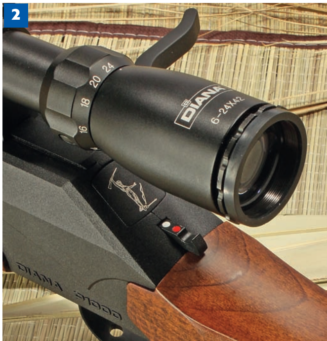
1 Zum Spannen und Repetieren schwenkt man den Seitenhebel, hier mit eingeschobenem Einzelschuss-Schieber. 2 Das Diana-ZF 6-24 x 42 hat einen Konterring für die Scharfeinstellung am Okular. Darunter die Schiebesicherung. 3 Mündung des WBK-Modells mit Tank (v. l.), dann der Schalldämpfer der F-Version und das Füllstück. Dauertest-Kurven: 4 F-Modell: sehr konstante v_0 bei über 530 Schuss. 5 200 Schuss aus der starken Version, mit deutlichen Schwankungen durch das Ventil.
