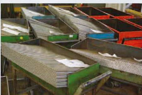
De lopen worden voorgeboord aangeleverd, maar ze zijn dan nog niet voorzien van trekken en velden.
