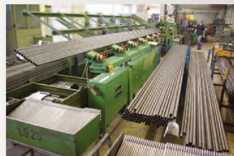
Deze vijf meter lange buizen zijn de basis voor het huis. Deels worden ze al afgekort geleverd, deels gebeurt dat bij Diana zelf.
