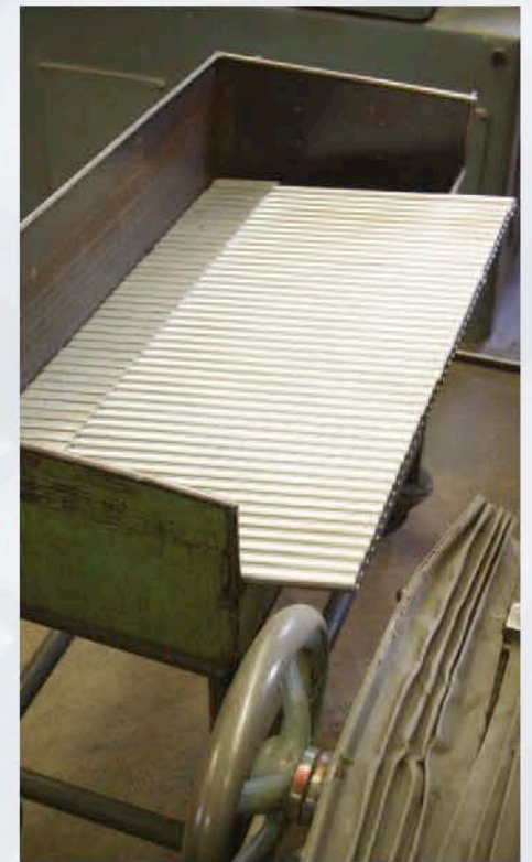
Ook de lopen met staartstuk worden gladgeslepen, en voor het bruinere gepolijst. Het is precisiewerk.
