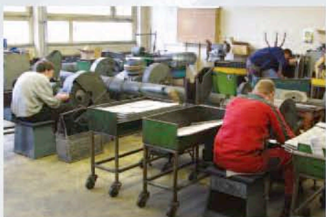
Ook de lopen met staartstuk worden gladgeslepen, en voor het bruinere gepolijst. Het is precisiewerk.
