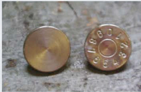
De stelschroef voor het vizier wordt op een dubbele pers van verdeling en groefjes voorzien. In de kartonnen doos zitten vijftienduizend kale schroeven. Dit soort onderdelen worden bij Diana in massa gemaakt, los van eventuele orders.
