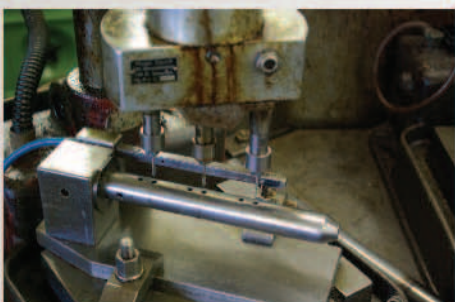
Met behulp van deze matrijs worden gaten geboord voor het viziervoetstuk.
