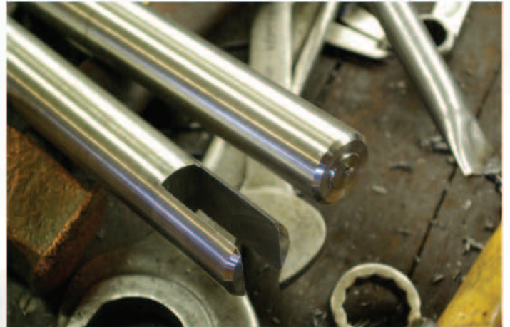
De sleuf voor het loopscharnier wordt gefreesd. Twintig kasten worden in twee rijen ingespannen in een machine met een dubbele frees.
