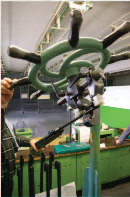
Deze meneer doet al een aantal decennia niets anders dan luchtbuksen inschieten. Kleine afwijkingen worden op het oog gecorrigeerd met een lopenricht-machine.
