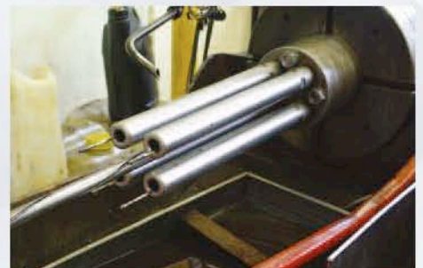
Op de trekbank worden vier lopen tegelijk voorzien van trekken en velden.
