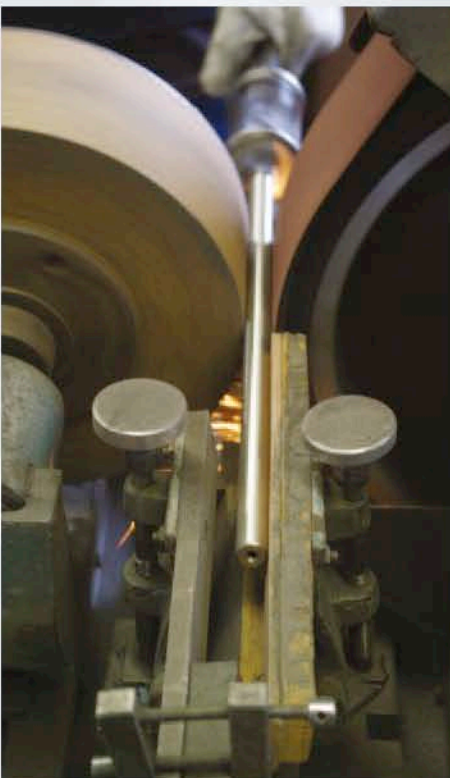
Ook de lopen met staartstuk worden gladgeslepen, en voor het bruinere gepolijst. Het is precisiewerk.
