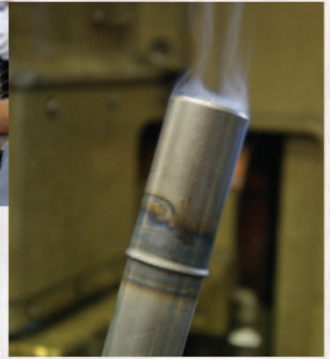
Deze machine zet het voorste massieve deel van het huis met een ringlas aan het achterste stuk.
