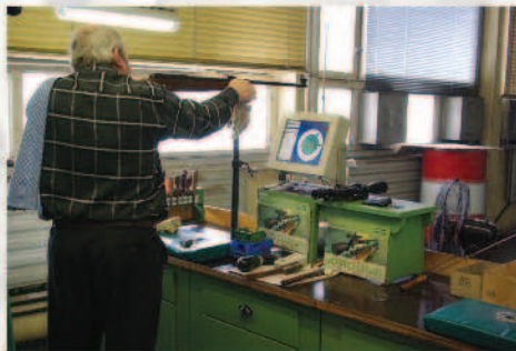
Deze meneer doet al een aantal decennia niets anders dan luchtbuksen inschieten. Kleine afwijkingen worden op het oog gecorrigeerd met een lopenricht-machine.
