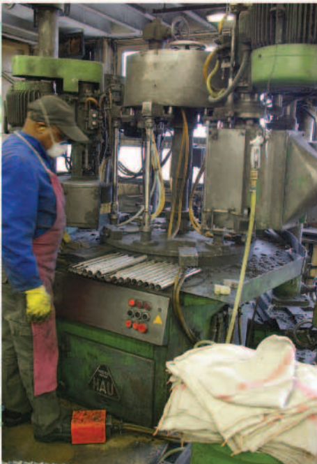
De huizen krijgen een laatste polijstgang, voor ze worden gebrúineerd. De gepolijste delen worden zorgvuldig in aparte lagen opgestapeld. De brúineermachine van Diana is computer-gestuurd. Een van de stappen in het proces is spoelen met water van tachtig graden.
