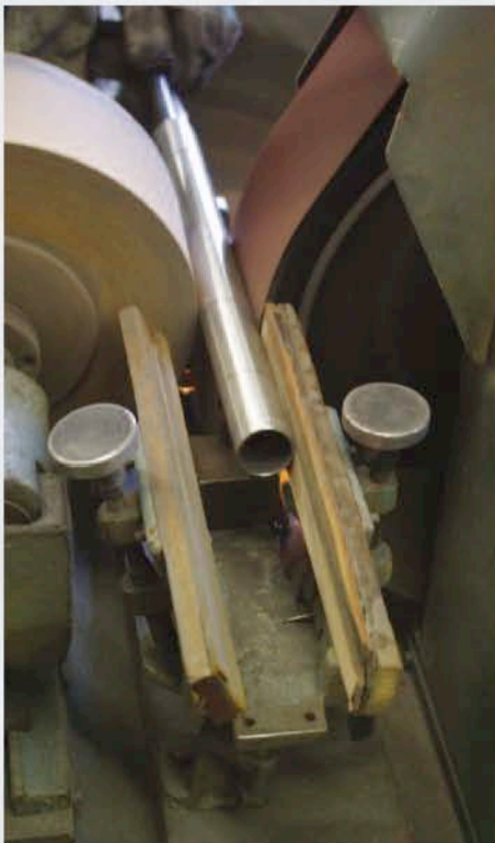
Hier worden de huizen gladgeslepen, met een steeds fijnere korrel. Het met de hand gladslippen is vakwerk.
