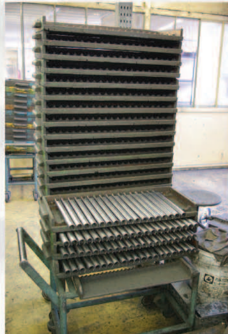
De huizen krijgen een laatste polijstgang, voor ze worden gebrúineerd. De gepolijste delen worden zorgvuldig in aparte lagen opgestapeld. De brúineermachine van Diana is computer-gestuurd. Een van de stappen in het proces is spoelen met water van tachtig graden.
