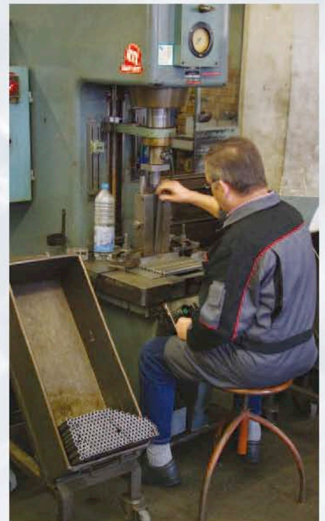
Elk onderdeel vergt verschillende bewerkingen. Hier worden de spanhendels afgerond.
