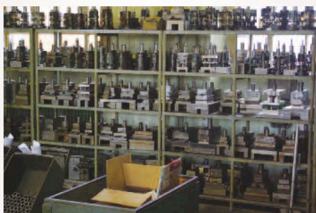
In de loop van zijn bestaan heeft Diana honderden modellen gemaakt, met duizenden verschillende onderdelen. Voor elk van die onderdelen heeft het bedrijf nog mallen en matrijzen, die her en der in de hallen staan opgestapeld.
