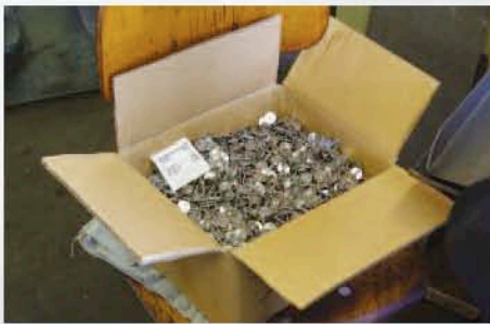
De stelschroef voor het vizier wordt op een dubbele pers van verdeling en groefjes voorzien. In de kartonnen doos zitten vijftienduizend kale schroeven. Dit soort onderdelen worden bij Diana in massa gemaakt, los van eventuele orders.
