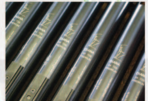
De laatste stap voor de montage is de lasergraving, met logo en model, maar soms ook de naam van de importeur.
