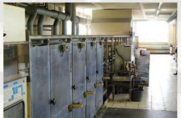
De huizen krijgen een laatste polijstgang, voor ze worden gebrúineerd. De gepolijste delen worden zorgvuldig in aparte lagen opgestapeld. De brúineermachine van Diana is computer-gestuurd. Een van de stappen in het proces is spoelen met water van tachtig graden.
