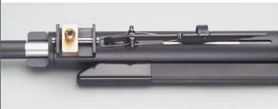
Ausgeschäftet. Die Spannhebelsicherung wird mit einer speziell gebogenen Drahtfeder durch eine Längsnut gegen den Luftzylinder gedrückt.
