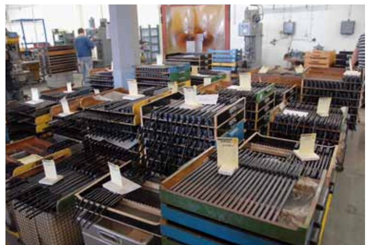
Deutsche Wertarbeit. Bei der Produktion der Druckluftwaffen kommt noch immer sehr viel echte Handarbeit zum Einsatz. Auch die alten Maschinen aus den 1950er-Jahren werden größtenteils noch genutzt. Ebenso werden die Einzelteile in der Montagehalle von Hand zusammengesetzt und dort einzeln getestet.
